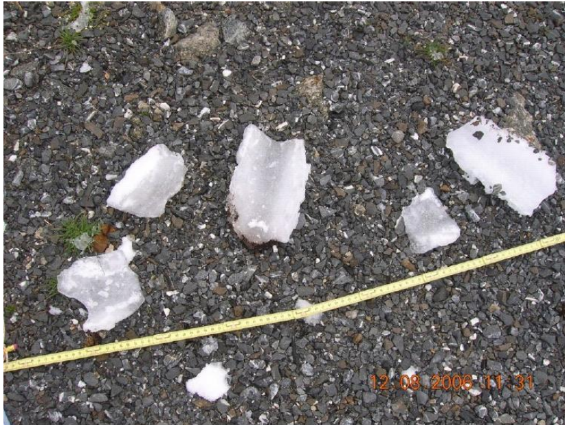
Kuva 2. Jääkimpaleiden sijaintitieto talletettiin, ne punnittiin ja mitattiin. E-40 voimalan lavan pituus on 20 m ja napakorkeus 50 m. Lähde: /1/
